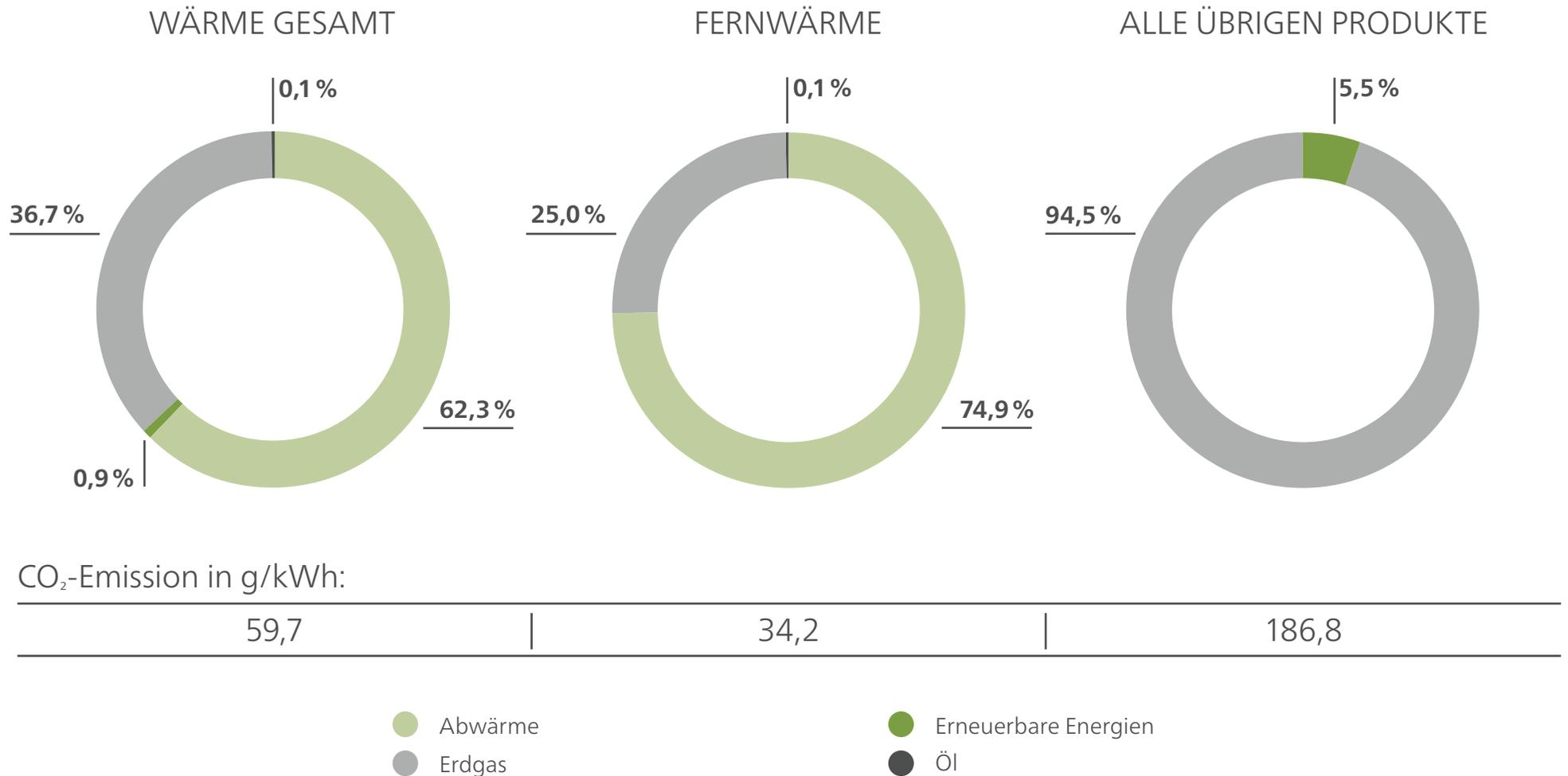
Die eingesetzten Energietechnologien für WÄRME GESAMT sind Müllverbrennung (61,6%), Kraft-Wärme-Kopplung (6,9%) und Heizkessel (31,5%).
