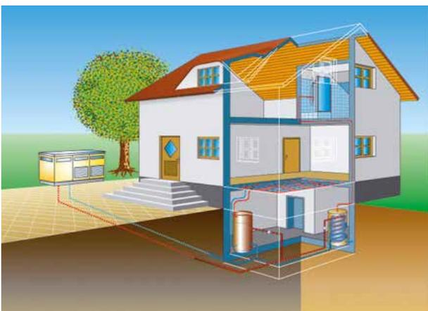
Mit einer Luft-/Luft-Wärmepumpe werden Lüftungswärmeverluste reduziert und dabei die Luftqualität erhöht.
