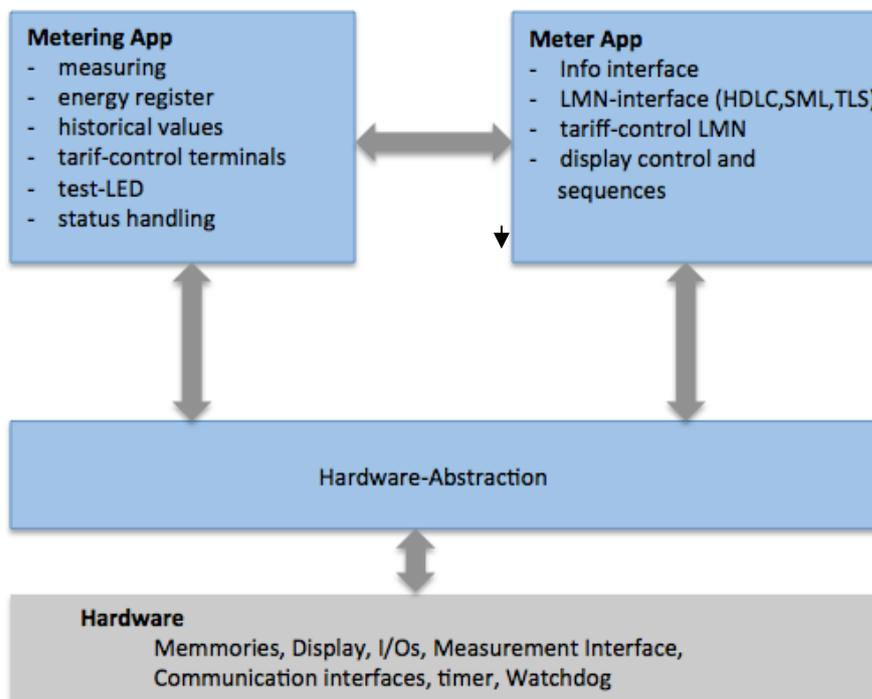
**Fig. 14: Firmware Struktur**
