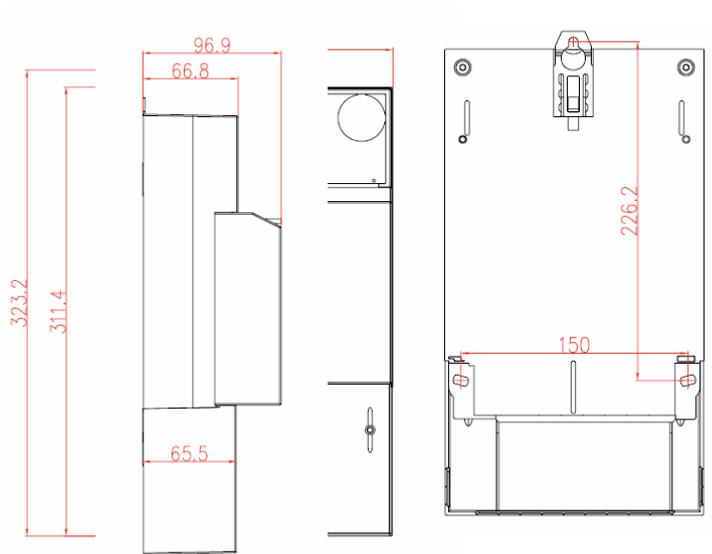
Fig. 2: Abmessungen Gehäuse
